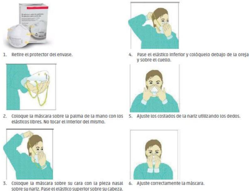
Para verificar que el protector respiratorio se encuentre correctamente colocado posicione las manos como se indica en el punto 5, Inhale y exhale suavemente, de ser necesario ajuste el pliegue de la nariz o los elásticos.
